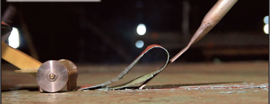
鋼板と塗膜間の界面結合が破壊され、塗膜が面白いように剥がれます
